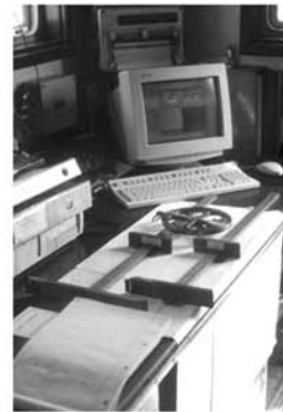
Duas balestilhas com soalhas diferentes. Note-se nos topos das soalhas as chapas de radiografia.
