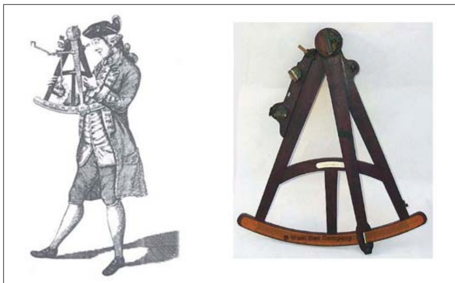
Figura 6. Octantes de la época. El de la izquierda tendrá los dos palmos y medio de rayo preconizados por Monteiro da Rocha. El de la derecha tiene la escala oblicua correspondiente al nóvio de Pedro Nunes.
